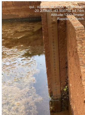
Figura 6-10: Monitoramento da vazão da drenagem interna da pilha noroeste
