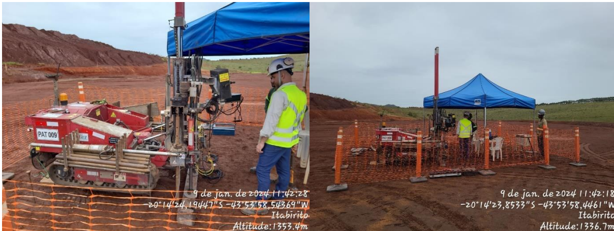
Figura 6-15: Furo SCPTU na pilha noroeste
