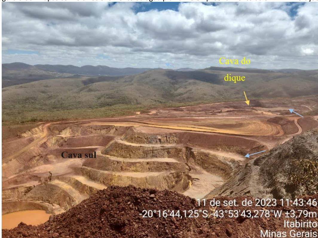
Figura 6-37: Duas cavas para as quais as águas pluviais são direcionadas na mina ponto verde.
