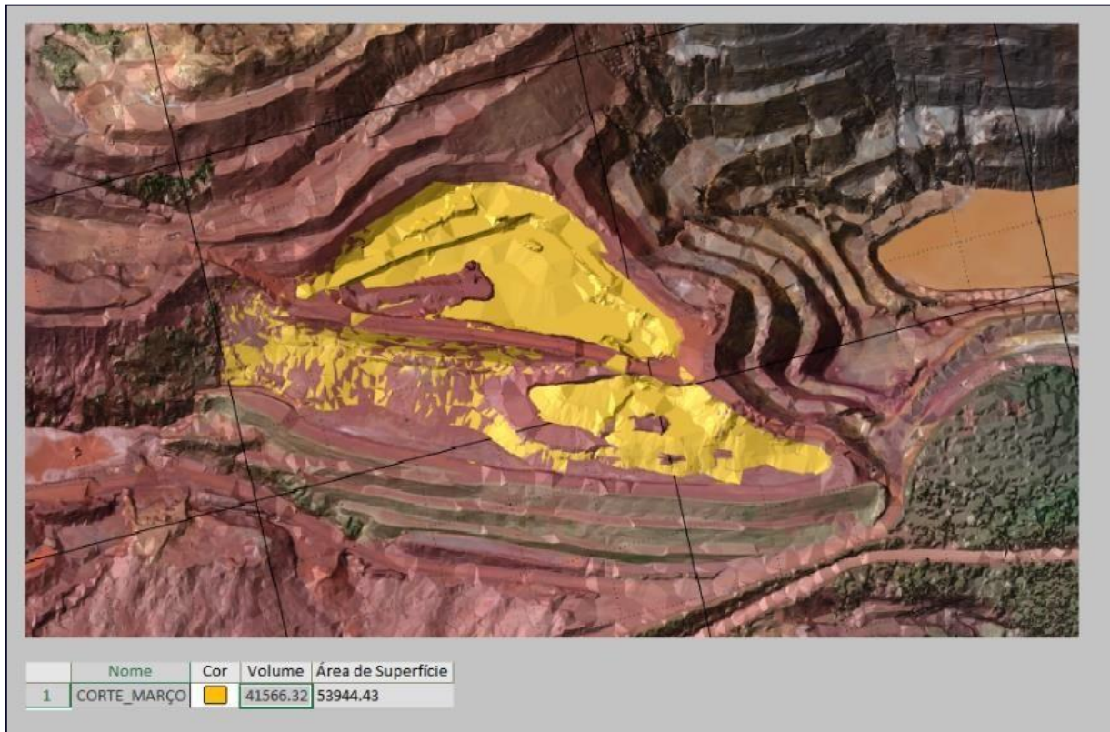
Figura 7.1-1: Volume Retirado na Barragem Aredes –Março/2023
