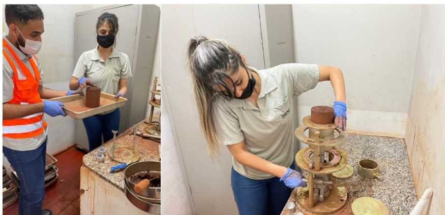
Figura 8-4: Ensaio de proctor normal realizados no laboratório da SAFM Mineração.
