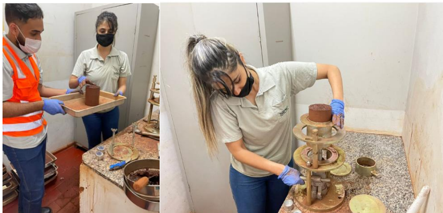
Figura 8-1: Ensaio de proctor normal realizados no laboratório da SAFM Mineração.
