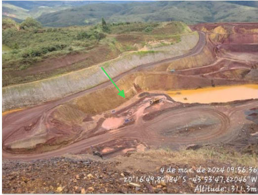
Figura 6-39: Cava sul. Água pluvial sendo retirada do fundo da cava para aspersão de poeira interna. Caminhão pipa sendo indicado com seta verde.
