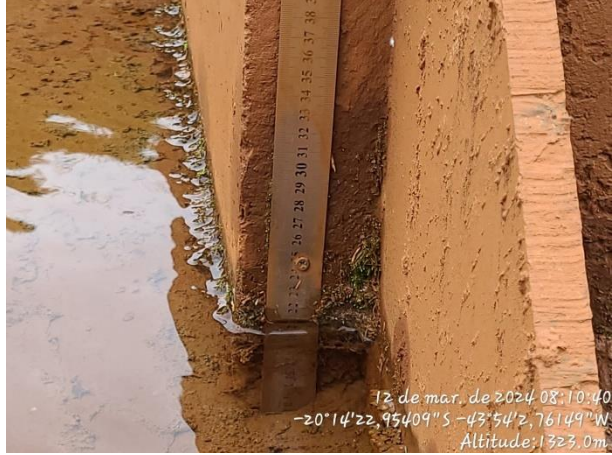
Figura 6-9: Monitoramento da vazão da drenagem interna da pilha noroeste
