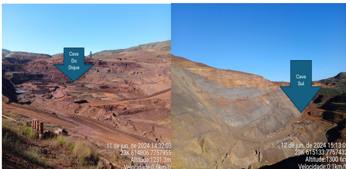
Figura 6-36: duas cavas para as quais as águas pluviais são direcionadas na mina ponto verde.
