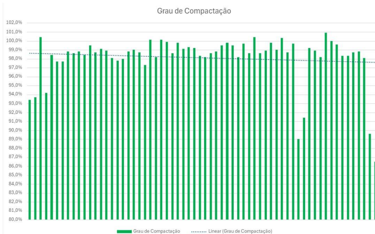
Figura 10: Grau de compactação obtido na pilha noroeste ao longo do trimestre. Apenas aquelas acima de 98% são aprovados.
