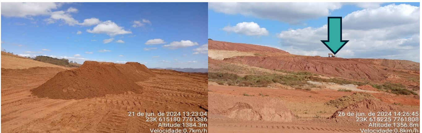
Foto 08: bota-espera de rejeito grosso na Praça 07 e empilhamento de estéril na Praça 06, respectivamente
