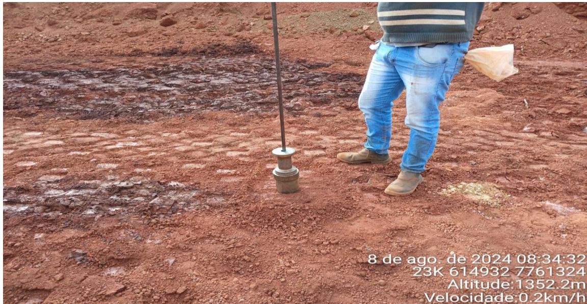
Foto 17: ensaio para determinação de umidade in situ e grau de compactação (Hilf). Componentes: haste guia, martelo de cravação, cabeçote metálico e cilindro biselado.
