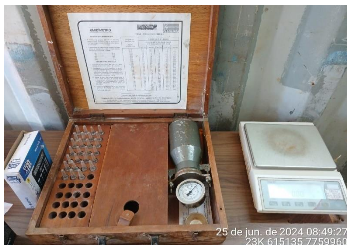
Foto 16: componentes utilizados para verificação da umidade in loco por intermédio do ensaio de Hilf. Calculadora, carbureto de cálcio, recipiente de Hilf com manômetro acoplado, balança de precisão, cápsulas de alumínio e tabela de verificação.
