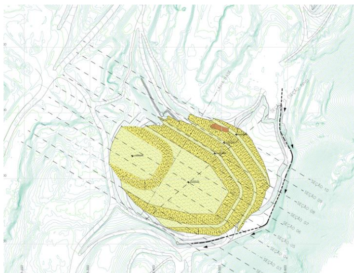
Figura 6-48: Canal de cintura ampliado ao longo que se avançará o processo de remoção da estrutura
