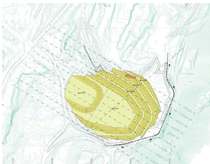
Figura 6-29: Canal de cintura ampliado ao longo que se avançará o processo de remoção da estrutura
