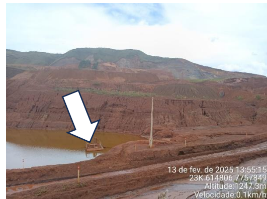
Figura 6-46: Sump (fundo da cava do dique) com a água pluvial sendo retida.
