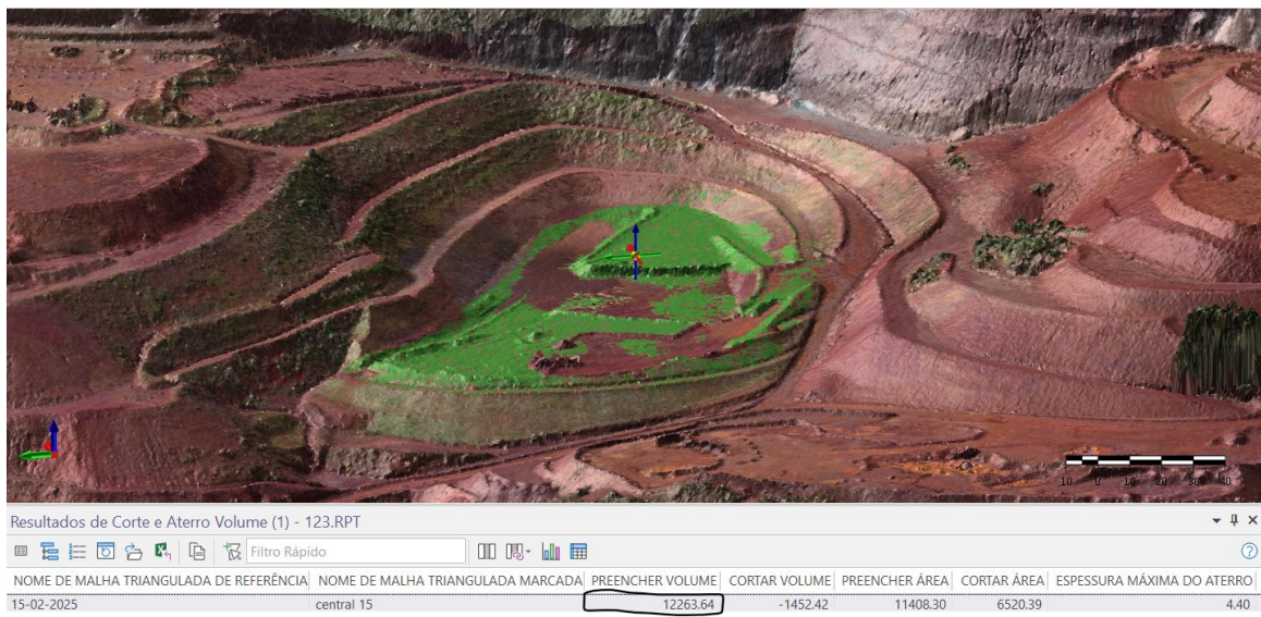
Figura 6: Volume removido em fevereiro de 2025.
